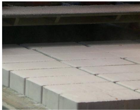
bassissimo impatto ambientale Carrara Block non necessita del processo di cottura in fornace: viene prodotto, infatti, attraverso la compressione delle materie prime che lo compongono, opportunamente umidificate. ■
